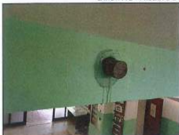
CAROTA T3 – PRELIEVO E PROVA DI CARBONATAZIONE
