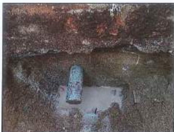
CAROTA TF4 – PRELIEVO E PROVA DI CARBONATAZIONE
