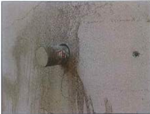
CAROTA T4 – PRELIEVO E PROVA DI CARBONATAZIONE
