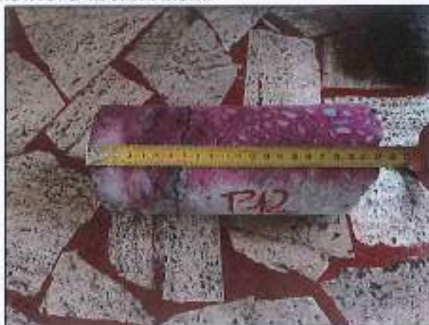
CAROTA P12 – PRELIEVO E PROVA DI CARBONATAZIONE
