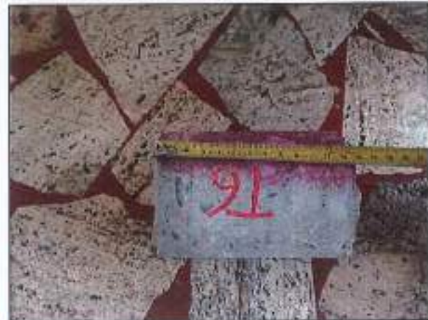
CAROTA T6 – PRELIEVO E PROVA DI CARBONATAZIONE
