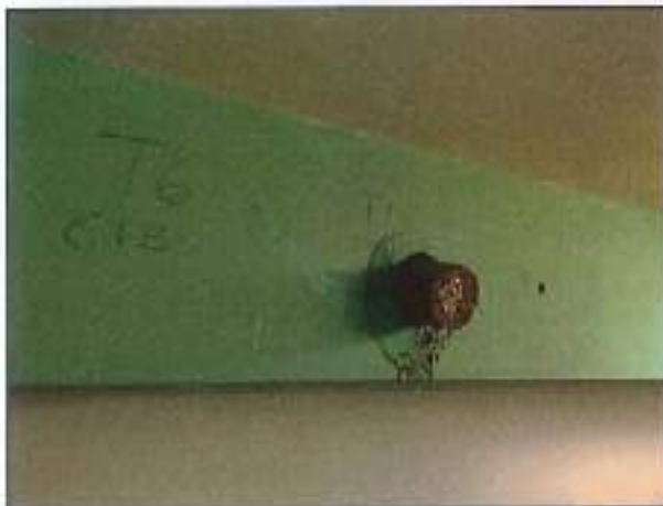
CAROTA T6 – PRELIEVO E PROVA DI CARBONATAZIONE
