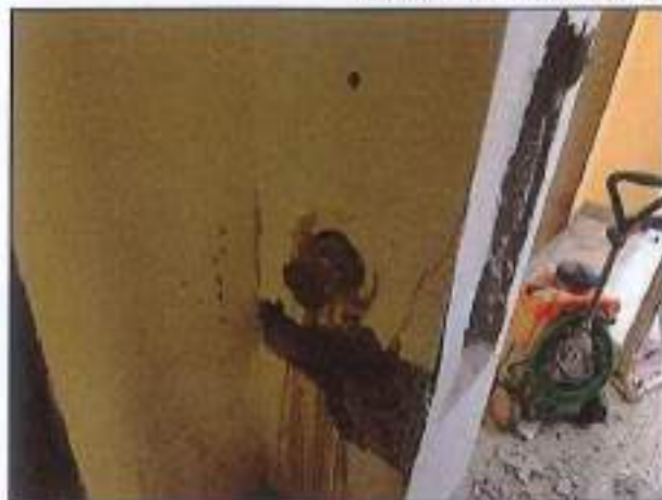
CAROTA P8 – PRELIEVO E PROVA DI CARBONATAZIONE
