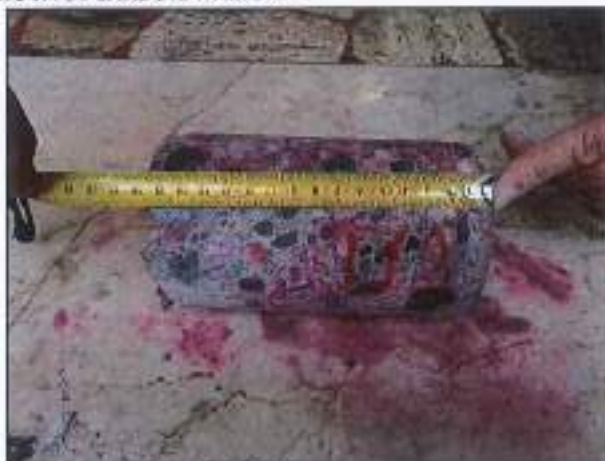
CAROTA T12 – PRELIEVO E PROVA DI CARBONATAZIONE
