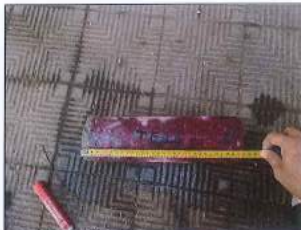
CAROTA TF1 – PRELIEVO E PROVA DI CARBONATAZIONE
