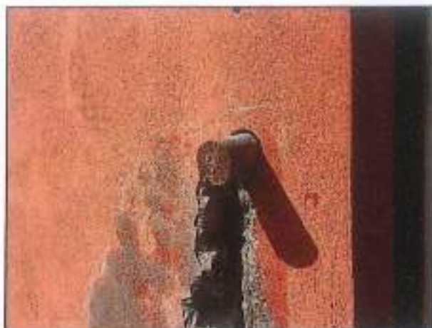
CAROTA P7 – PRELIEVO E PROVA DI CARBONATAZIONE
