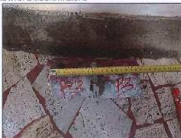
CAROTA P3 – PRELIEVO E PROVA DI CARBONATAZIONE
