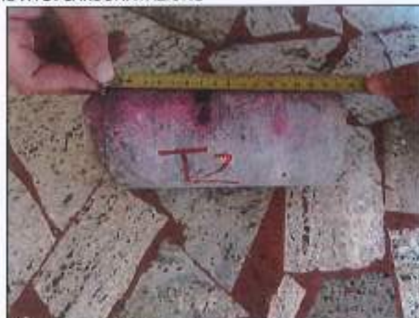
CAROTA T2 – PRELIEVO E PROVA DI CARBONATAZIONE
