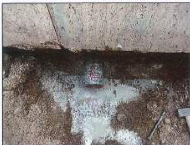
CAROTA TF3 – PRELIEVO E PROVA DI CARBONATAZIONE
