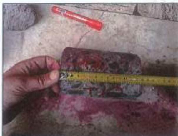
CAROTA T10 – PRELIEVO E PROVA DI CARBONATAZIONE
