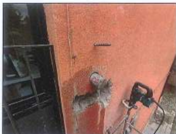
CAROTA P10 – PRELIEVO E PROVA DI CARBONATAZIONE
