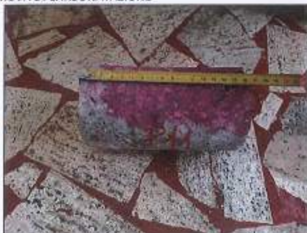
CAROTA P11 – PRELIEVO E PROVA DI CARBONATAZIONE
