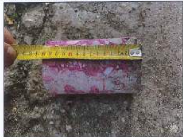
CAROTA T5 – PRELIEVO E PROVA DI CARBONATAZIONE
