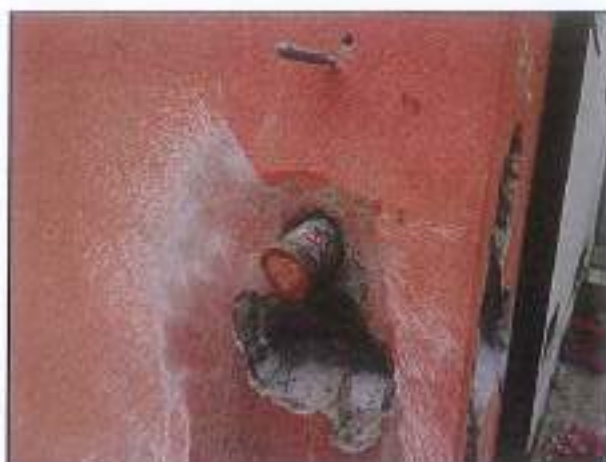
CAROTA P1 – PRELIEVO E PROVA DI CARBONATAZIONE
