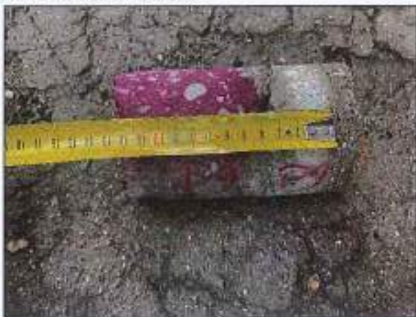
CAROTA P9 – PRELIEVO E PROVA DI CARBONATAZIONE
