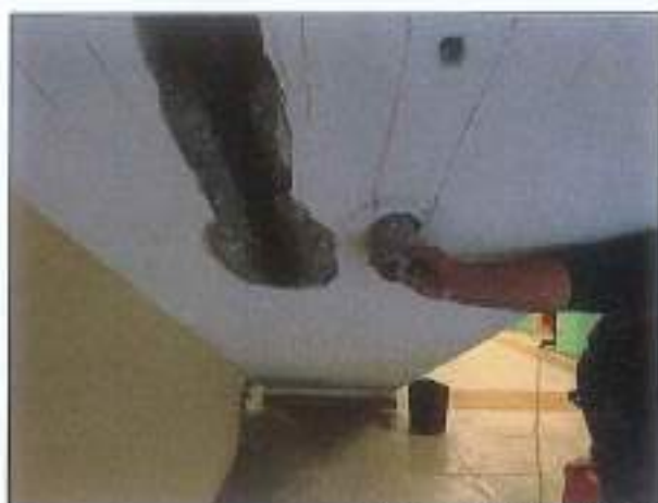
CAROTA SCI – PRELIEVO E PROVA DI CARBONATAZIONE
