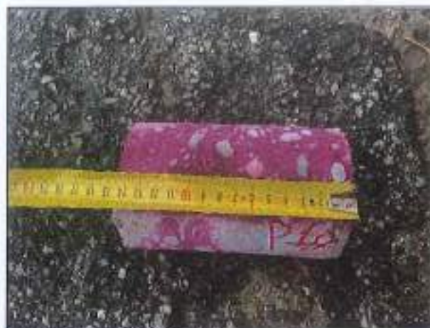
CAROTA P10 – PRELIEVO E PROVA DI CARBONATAZIONE
