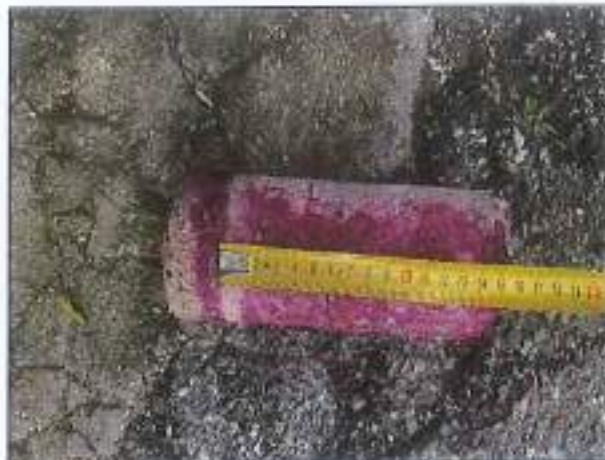
CAROTA P4 – PRELIEVO E PROVA DI CARBONATAZIONE
