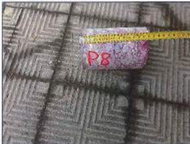
CAROTA P8 – PRELIEVO E PROVA DI CARBONATAZIONE
