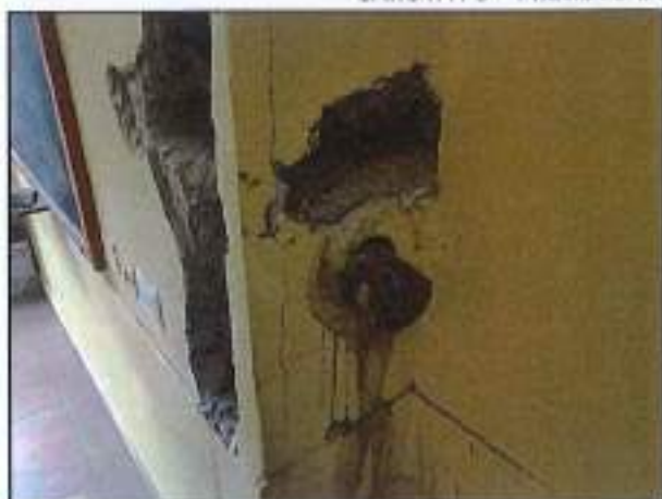
CAROTA P6 – PRELIEVO E PROVA DI CARBONATAZIONE
