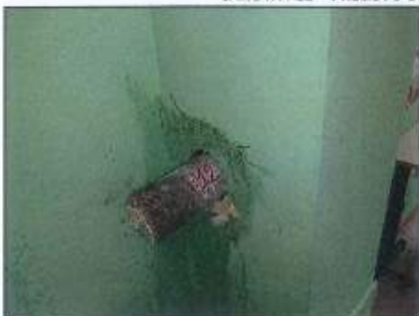
CAROTA P12 – PRELIEVO E PROVA DI CARBONATAZIONE
