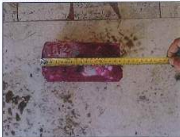
CAROTA TF2 – PRELIEVO E PROVA DI CARBONATAZIONE
