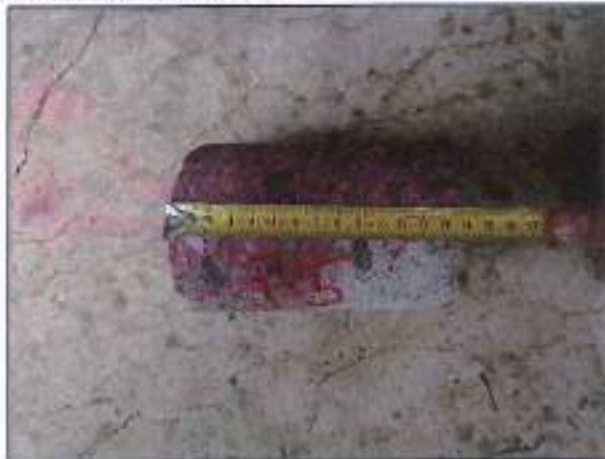
CAROTA P5 – PRELIEVO E PROVA DI CARBONATAZIONE
