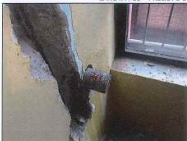
CAROTA P11 – PRELIEVO E PROVA DI CARBONATAZIONE
