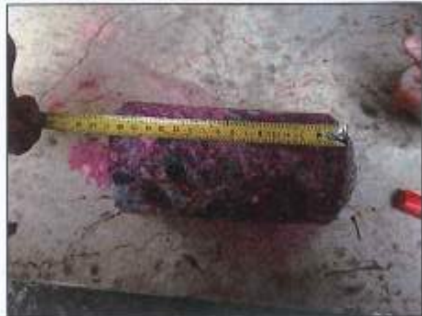
CAROTA T9 – PRELIEVO E PROVA DI CARBONATAZIONE
