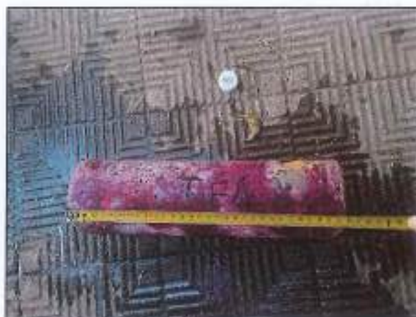
CAROTA TF4 – PRELIEVO E PROVA DI CARBONATAZIONE
