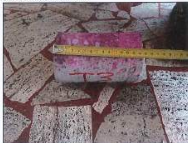
CAROTA T3 – PRELIEVO E PROVA DI CARBONATAZIONE
