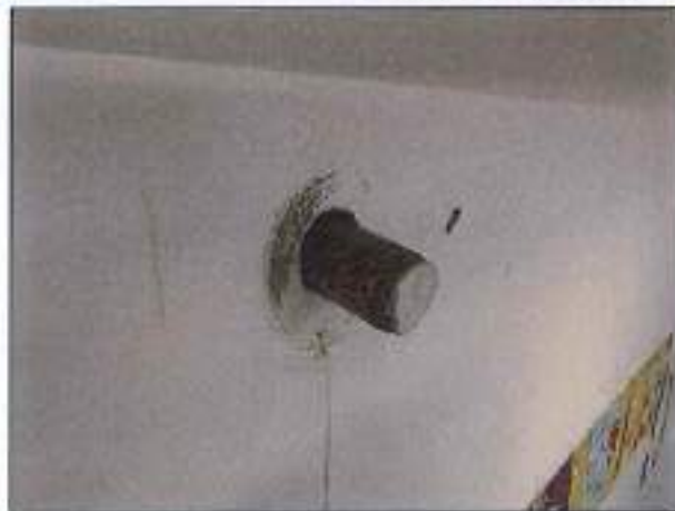
CAROTA T8 – PRELIEVO E PROVA DI CARBONATAZIONE
