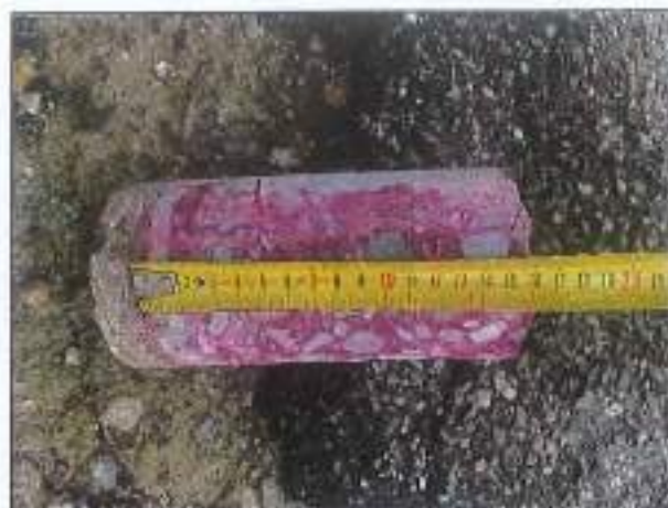
CAROTA T1 – PRELIEVO E PROVA DI CARBONATAZIONE
