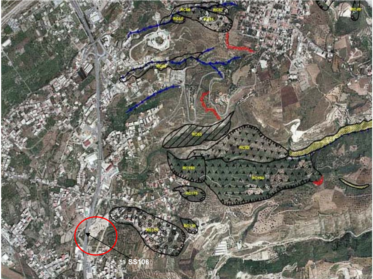
Figura 6-1 - Stralcio "Perimetrazione centri abitati instabili", TAV. FCI 080-063 del Comune di Reggio Calabria, Loc Gallina.
